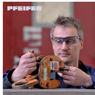
Funktionsprüfung bei Klemmen
