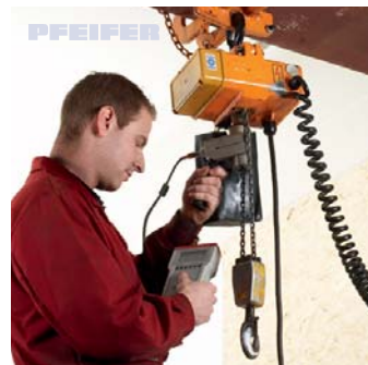
Prüfung der Rutschkupplung bei Elektro-Kettenszügen
